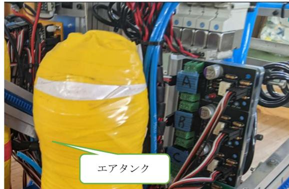
ロボットに実装した回路 (エアタンク、電磁弁)
