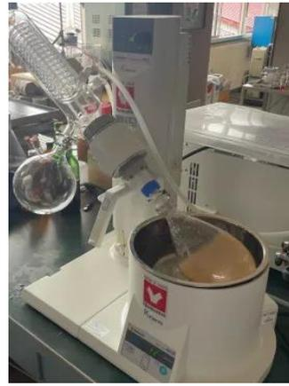
図4 ロータリーエバポレーターによる濃縮
