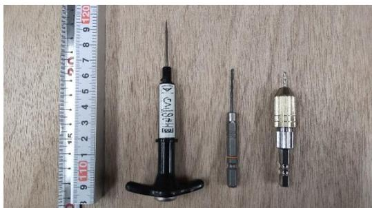
写真4 電動用精密ドリルチャック【右】
